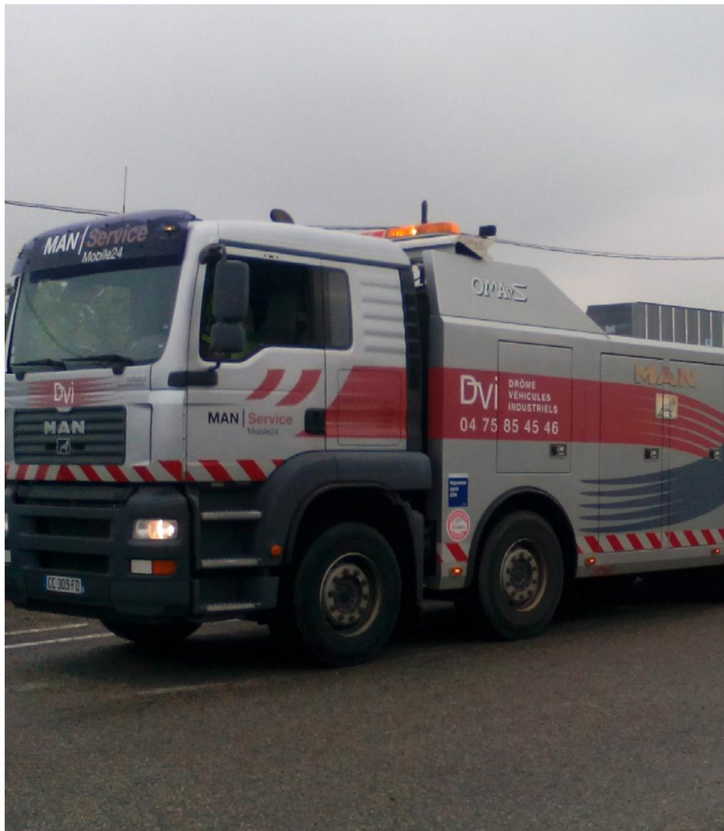
➤ Bras OMARS F 110 T (charge utile 30 tonnes) : **2 treuils 18 et 30T**
